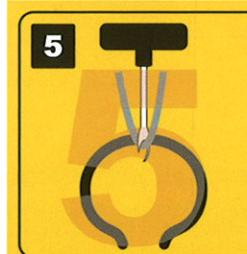
5 Enfoncer la mèche de réparation dans le trou à l'aide de l'outil crochet jusqu'à ce qu'il ne dépasse plus que d'environ 1,5 cm, puis tournez le d'un quart de tour, avant de le retirer avec précaution
