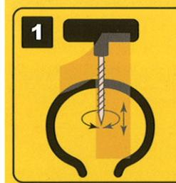
1 Préparez le trou pour la réparation, à l'aide de l'alésoir par mouvements de rotation, et aussi en tirant et poussant vigoureusement.
